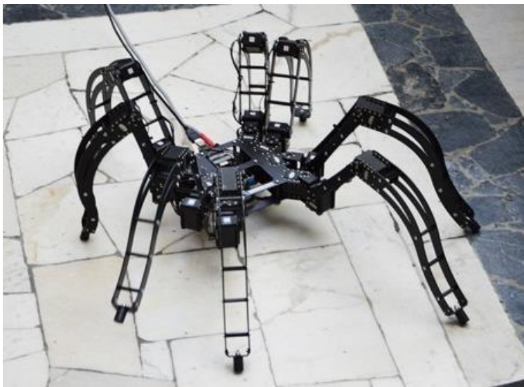
Robot pająk wykonany w skali 7 : 1 w stosunku do rzeczywistej czarnej wdowy
